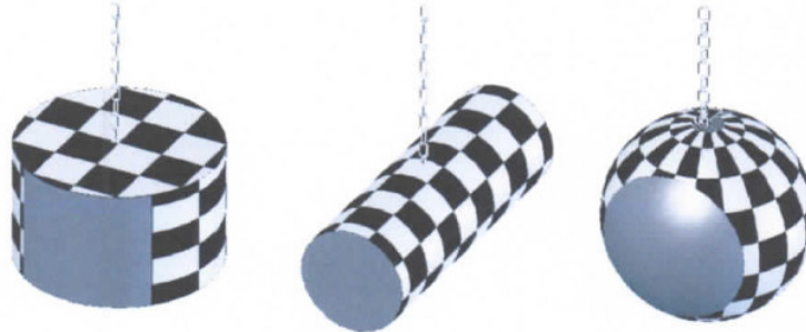
figura C.2 Campione di corpo duro che mostra l'area dell'urto
